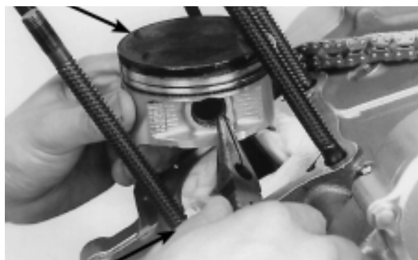
BULÓN DEL PISTÓN/SUJETADOR DEL BULÓN PISTÓN
